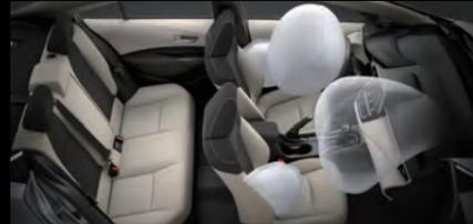
أكياس الهواء: للمساعدة على تخفيف الصدمة التي يتعرض لها المتواجدون في السيارة في حالة التصادم، تأتي سيارة كورولا مجهزة بكيس هواء SRS للسائق وكيس هواء SRS للراكب الأمامي وأكياس هواء SRS جانبية (للمقاعد الأمامية).\*2
