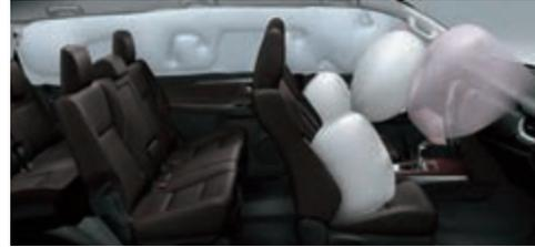
**أكياس الهواء:** سيارة فورتنر مجهزة بكيس هوائي SRS للسائق وكيس هوائي SRS للراكب الأمامي وكيس هوائي SRS للركبتين (مقعد السائق) وكيس هوائي SRS جانبي (المقاعد الأمامية) وأكياس الدرع الستائري (SRS) للمقاعد الأمامية والخلفية.١٠
